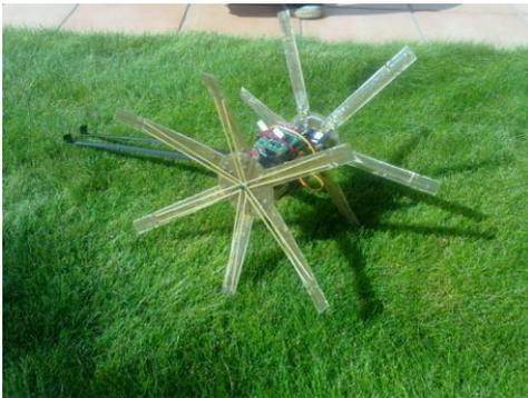
el dispositivo toca el suelo despliega las ruedas y gracias al GPS, a la brújula y al algoritmo de navegación se orienta y se desplaza hacia las coordenadas fijas que determina la organización del concurso”, explican.
